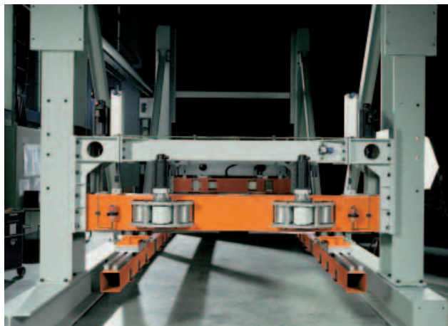
Bild 2: Für die Lagerregelung des 3-achsigen Transfersystems entschied sich Schuler für eine software-basierte Motion Control Lösung. TwinCAT NC PTP besitzt eine Achspositionierung, eine integrierte Software-SPS mit NC-Schnittstelle, Bedienprogramme zur Inbetriebnahme und eine E/A-Anbindung der Achsen über den Feldbus.
