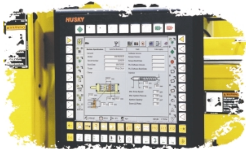
Die kundenspezifische Bedieneinheit mit TFT-Bildschirm, Touchscreen, Softkey-Tasten und Benutzer-ID basiert auf dem Standard-Control Panel von Beckhoff
