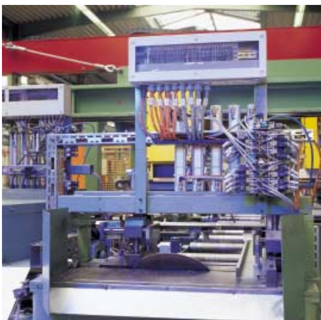
Neun Servoachsen steuert die Soft-SPS/NC TwinCAT an der Säge- und Verteilanlage; der Lageregler wird auf dem PC-Prozessor gerechnet und tauscht zyklisch Daten über den Feldbus mit Antrieben und Messsystemen aus
