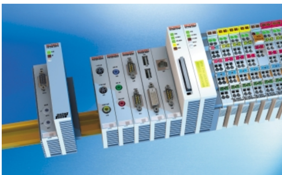
Feldbusanschlüsse sind sowohl in Master- oder Slave-Varianten für unterschiedliche Bussysteme möglich – auch mehrere verschiedene gleichzeitig
