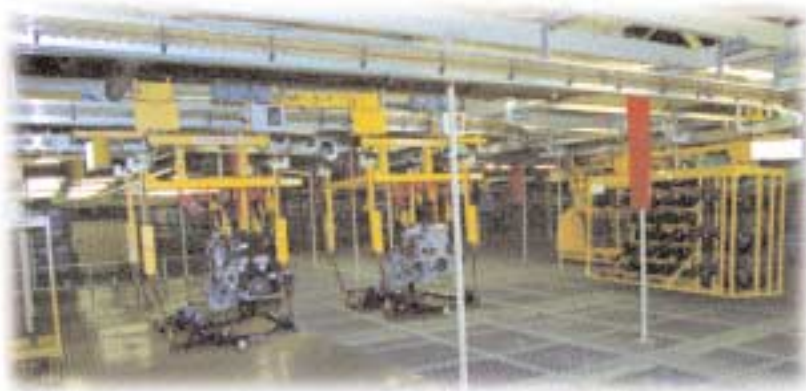
Etwa alle 45 Sekunden fördert eine Elektrohängebahn die für den Ford Mondeo erforderlichen Ausstattungsvarianten ans Band.
