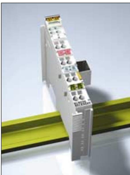
3 In der KL9020 werden die K-Bus-Signale auf RS485 umgesetzt
