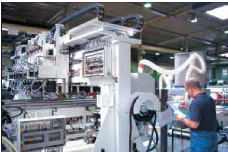
2 Dank des PC-Steuerungsansatzes braucht der Maschineneinrichter nur noch die Maßdaten aus der Kundenzeichnung am Control-Panel einzugeben
