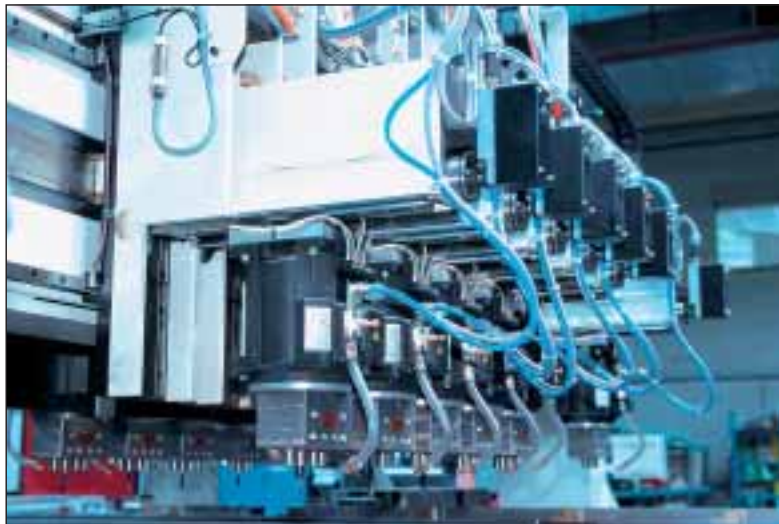
3 Die Linear-motoren ermöglichen präzises Positionieren in kompakter Bauweise
