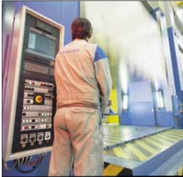
PC-based Control in den hydraulischen Tryout-Multi-curve-Pressen von Müller Weingarten im Einsatz bei Volkswagen. Neben dem Lightbus zur Kommunikation zwischen Rechner und Sensorik kommt hier Sercos Interface für die elektrischen Antriebe und Profibus-DP für die Ankopplung der übergeordneten Anlagenteile zum Einsatz.
