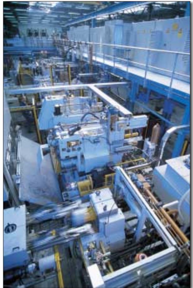
Überblick über die 200 Meter lange Hayes-Lemmerz-Felgenstraße, bestehend aus den Einheiten Haspel, Schweißen und Profilieren.
