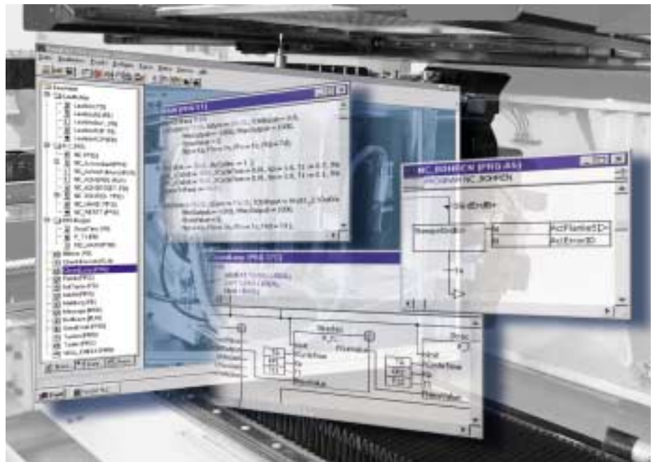
1: Die Software TwinCAT PLC erlaubt die Programmierung von bis zu vier virtuellen „SPS-CPU“ mit jeweils bis zu vier Anwendertasks auf einem PC
