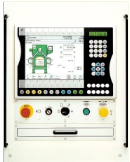
Abb. 5: Die Bedien- und Programmieroberfläche ist in Visual-Basic 6.0 ausgeführt und über Standardschnittstellen an die Steuerung gekoppelt.
