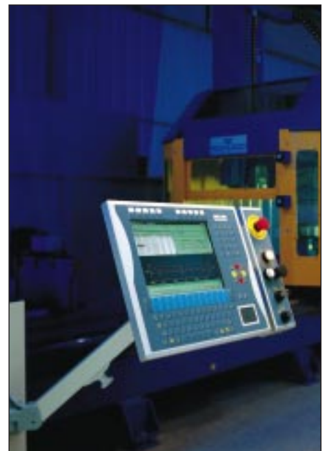
2 Das PC-Bedienfeld ist mit der Rechereinheit des Profil-Bearbeitungssystem in einer Entfernung von bis zu 65 m über zwei Koaxialleitungen verbunden (Bild: Schüco)
