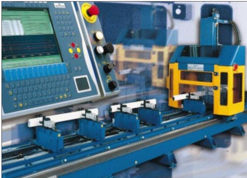
1 Durch das optimale Zusammenspiel aller Komponenten und einfache Bedienung mittels Control Panels von Beckhoff lassen sich mit dem Profil-Bearbeitungssystem von Schüco sehr gute Ergebnisse erzielen (Bild: Schüco)
