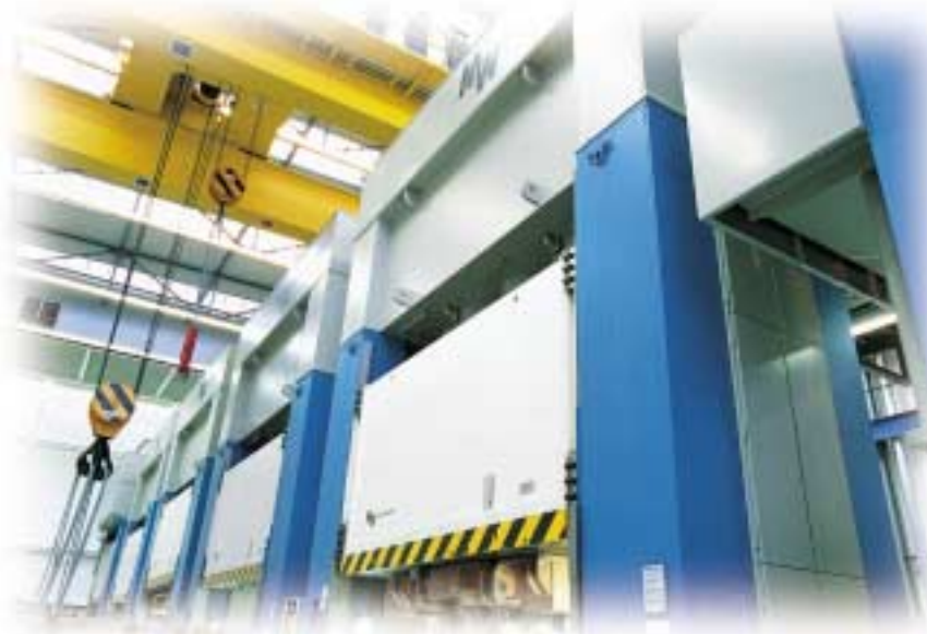
Die hydraulische Tryout-Multicurve-Pressen von Müller Weingarten im Einsatz bei Volkswagen. Im Wolfsburger Automobilkonzerns simulieren insgesamt sechs Pressen die reale Produktionsumgebung, bevor die Werkzeuge in die Serienfertigung gehen.
