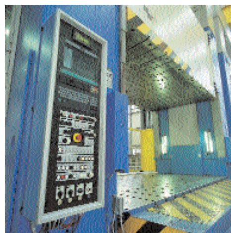
Bild 3. Leistungsträger: Pressensteuerung auf PC-Basis (links) mit einer Automatisierungssoftware, die SPS-Funktionalitäten, Motion Control sowie Programmierumgebung vereint
