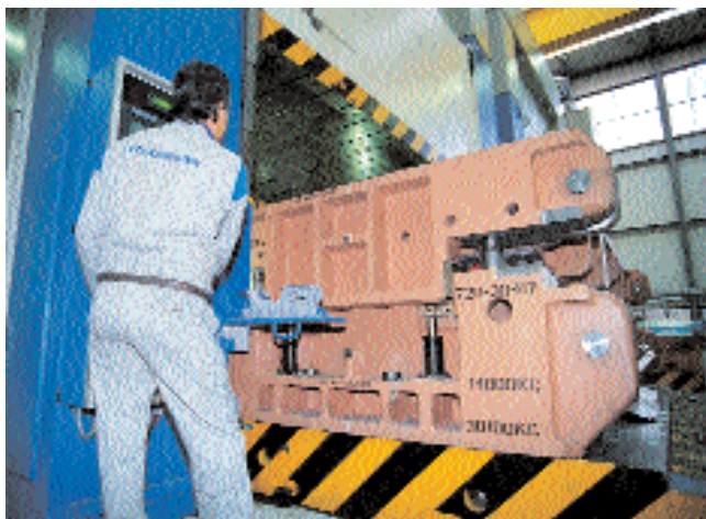
Bild 2. Optimierte: Maschinenspezifisch »eingearbeitetes« Presswerkzeug zum wirtschaftlichen Fertigen ab Losgröße Eins
