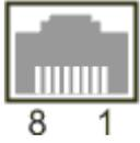
An die Ethernet-Schnittstelle (X610) können auch Nicht-PoE-fähige Geräte angeschlossen werden. Das Systemmodul CX2500-0061 überprüft angeschlossene Geräte vor dem Start und testet die Geräte auf ihre PoE-Fähigkeit.
