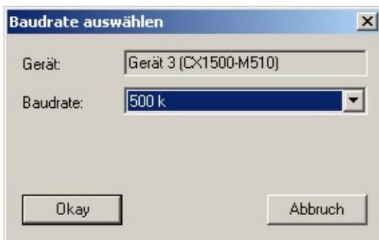
Der Scanlauf durchläuft alle Node-IDs. Sollten sich beim Scanlauf die Boxen nicht finden, so muss der Anwender die Verkabelung und die Betriebsbereitschaft der Boxen prüfen. Identische Node-IDs führen z.b: dazu, dass sich beide Nodes nicht finden lassen. Ist der Scan durchlaufen, werden die gefundenen Boxen angezeigt.
