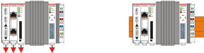
Anschließend wird der CX1020-Block mit Hilfe der Verriegelungsglaschen auf der Hutschiene fixiert. Dabei sollte ein leises Klicken zu vernehmen sein.
