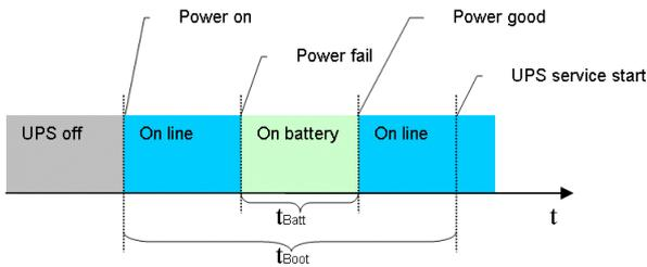
Der USV-Dienst ist zu diesem Zeitpunkt noch nicht aktiv. Die USV schaltet automatisch auf Batteriebetrieb um und überbrückt so den Stromausfall. Der PC wird auf Batteriespannung hochgefahren. Handelt es sich aber um einen längeren Stromausfall dann übernimmt der USV-Dienst nach dem Start die Kontrolle und beginnt mit dem Shutdown.
