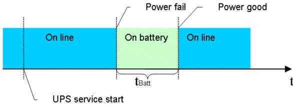
Der USV-Dienst ist gestartet und aktiv. Kurze Stromausfälle werden durch die USV überbrückt. Ein Shutdown durch den USV-Dienst wird nicht initiiert.
