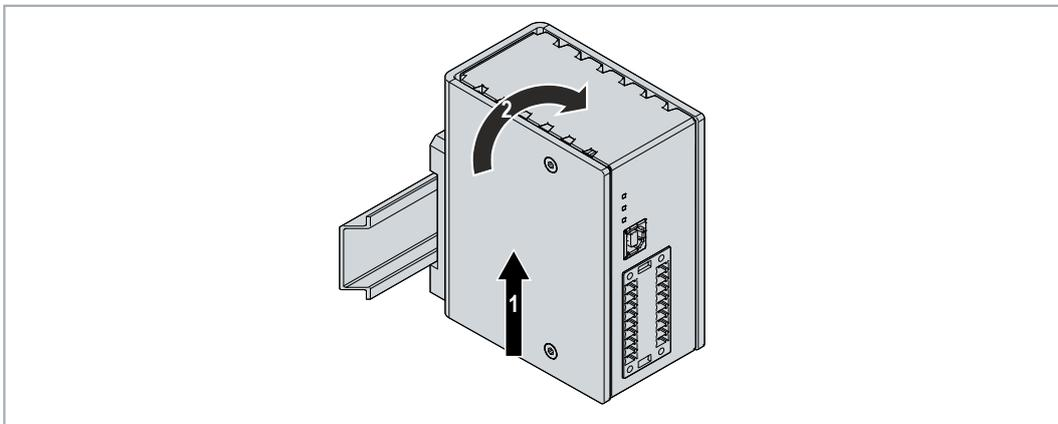
⇒ Sobald Sie die USV nach oben drücken, geben die unteren Federn der Hutschieneadapter nach. Auf diese Weise lässt sich die USV von der oberen Kante der Hutschiene lösen.
