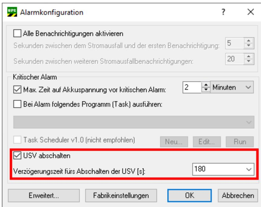
Die Ausgänge der USV werden nach Ablauf der Verzögerungszeit unwiderruflich abgeschaltet, auch wenn die Spannungsversorgung wiederkehrt.
