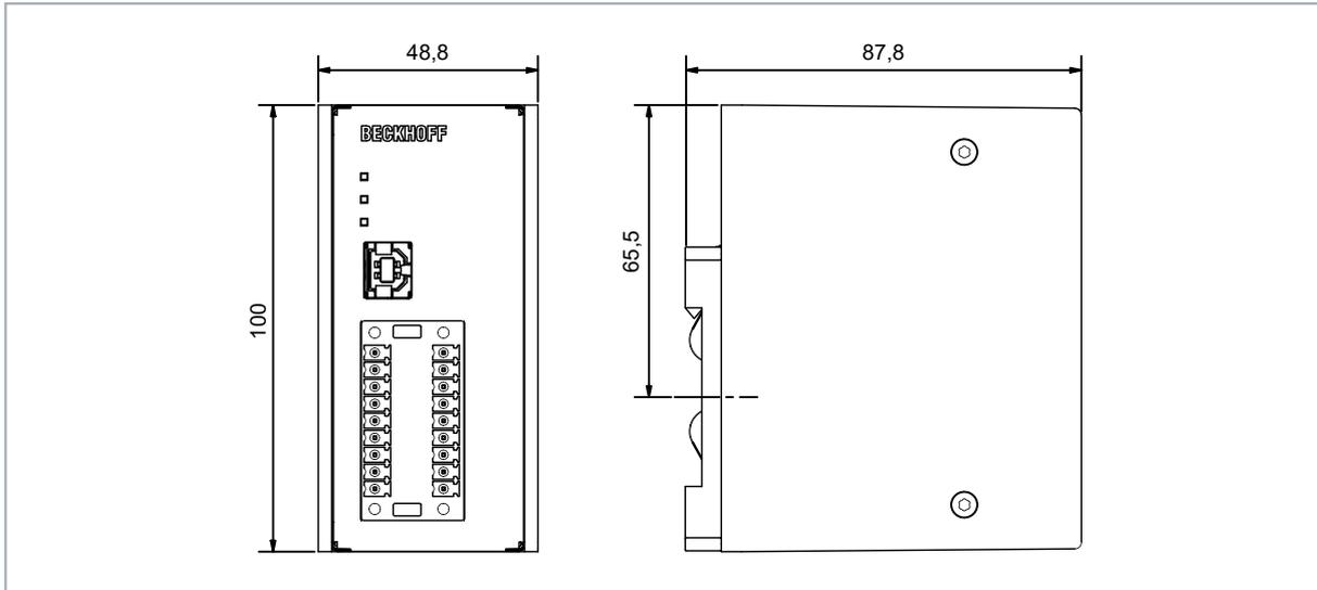
Abb. 8: CU8110-0060 Abmessungen.
