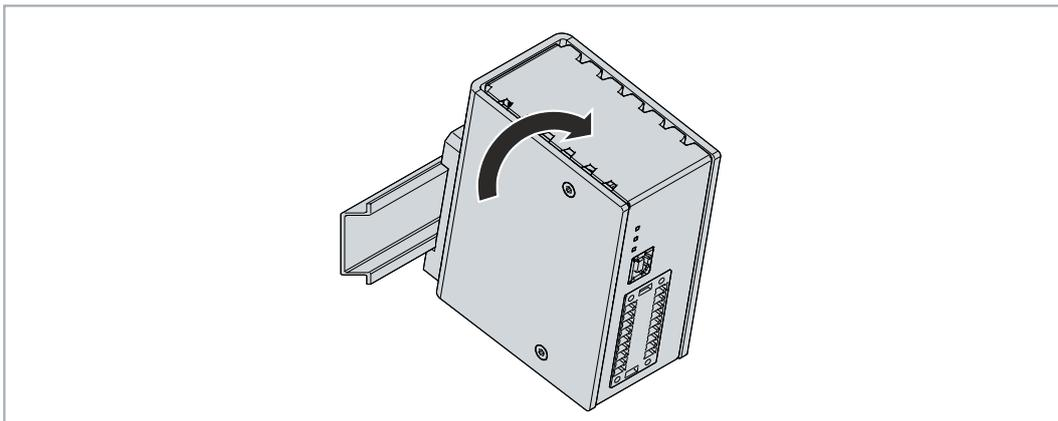
⇒ Die USV lässt sich von der Hutschiene lösen.
