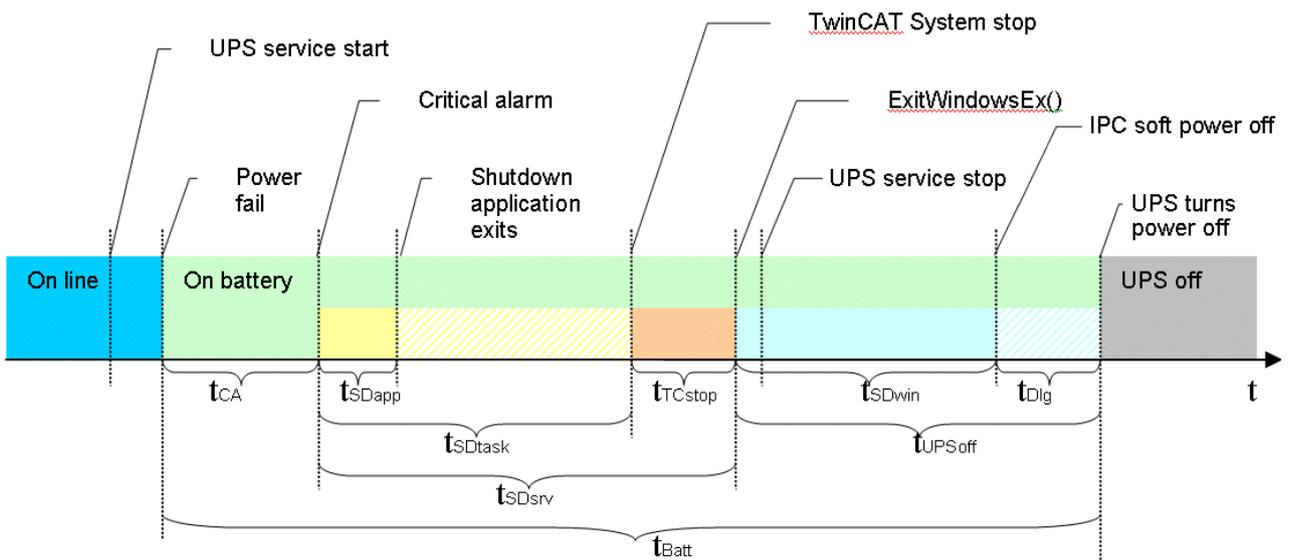
**Kurze Stromausfälle im Betrieb ( $t_{Batt} < t_{CA}$ )**
