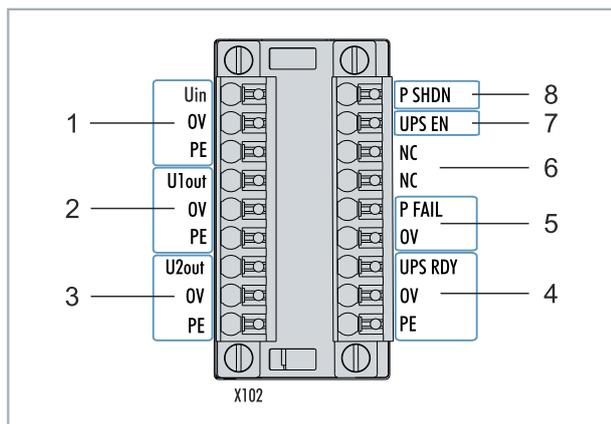
Abb. 7: Spannungsversorgung X102.
