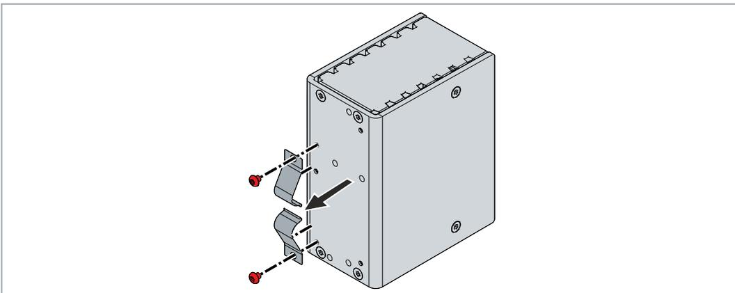
3. Befestigen Sie die Montageplatte mit vier M4-Schrauben an der USV-Rückwand.
