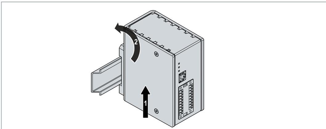
⇒ Sobald Sie die USV nach oben drücken, geben die unteren Federn der Hutschieneadapter nach. Auf diese Weise lässt sich die USV auf der oberen Kante der Hutschiene befestigen.
