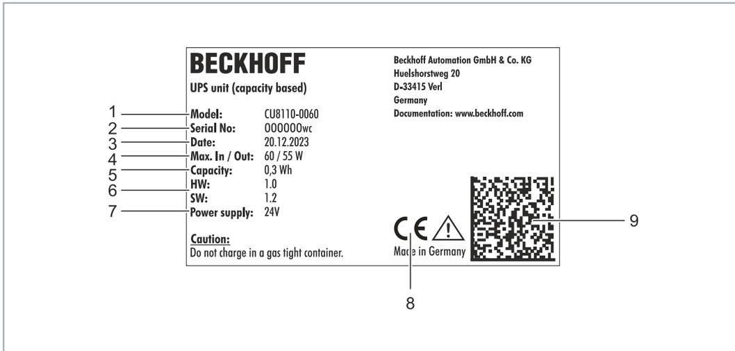
Abb. 2: Typenschild Beispielansicht.
