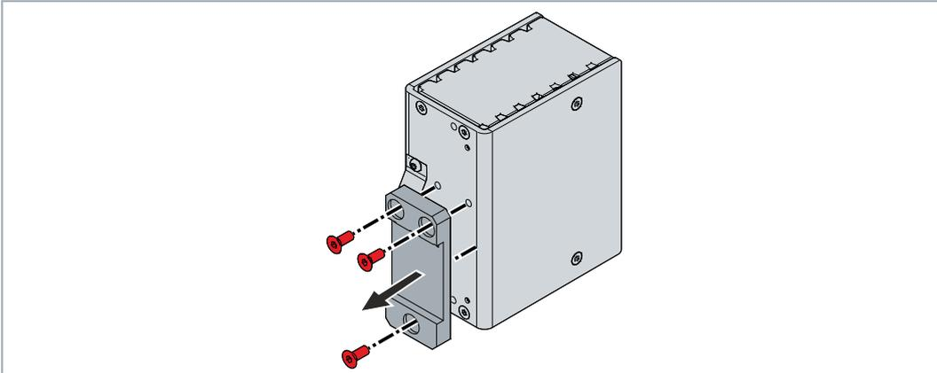
2. Lösen Sie die M3-Schrauben und entfernen Sie die Erdungsfedern von der USV.
