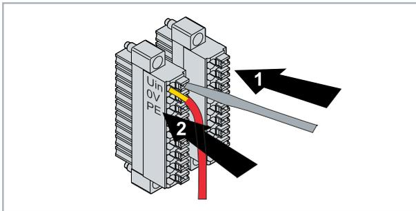
2. Der Draht kann nun ohne Widerstand in die runde Klemmenöffnung eingeführt werden.
