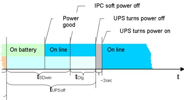
Nachdem der USV-Dienst mit dem Shutdown begonnen hat, kann dieser Vorgang nicht mehr gestoppt werden und wird konsequent bis zum Ende durchgeführt. Erneute Stromausfälle während des Shutdowns werden von der USV überbrückt. Um ein erneutes Wiederanlaufen des IPCs zu ermöglichen, wird auch bei einer vorhandenen externen Spannungsversorgung diese kurz (für einige Sekunden) unterbrochen.
