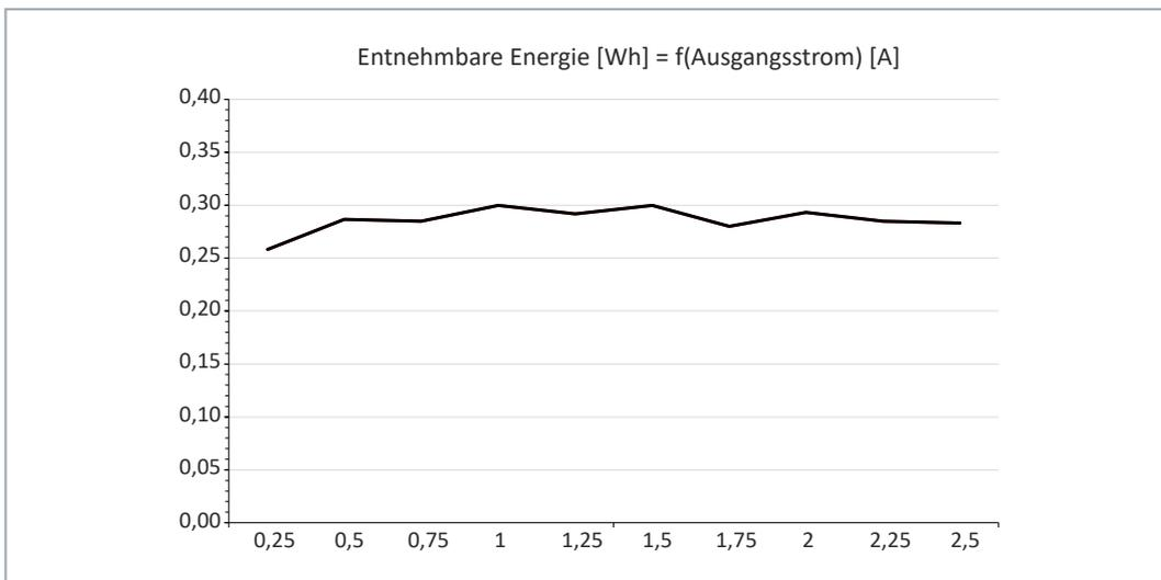
Abb. 5: Entnehmbare Energie ohne Temperatur- und Alterungseffekte.
