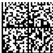
Abb. 32: Beispiel-DMC 1P 072222 SBTN k4p562d7 1K EL1809 Q 1 51S 678294
