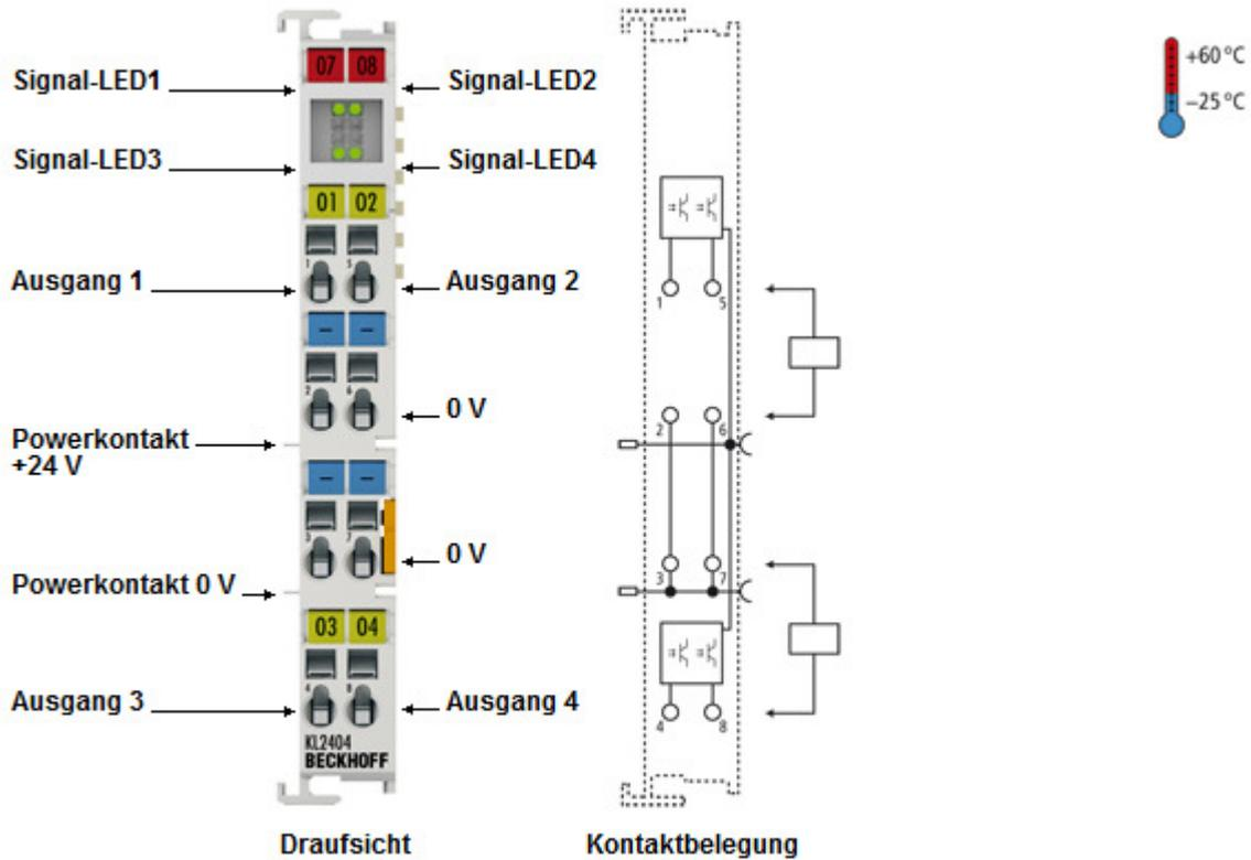
**KL2404, KL2424 | 4-Kanal-Digital-Ausgangsklemmen 24 V DC**
