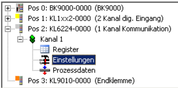
Abb. 18: KS2000 - Anzeige der Feldbusstation
