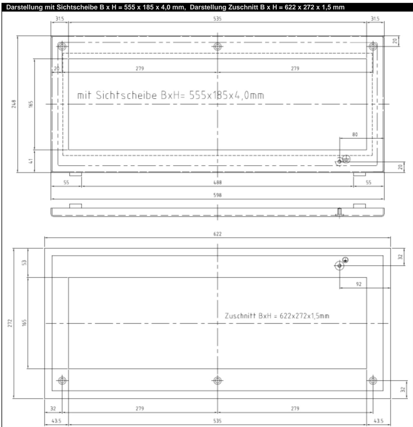
Mit 3 x Deckelbefestigungswinkel oben, Erdungsbolzen und beigelegter Tragschiene SZ35/15 x 587 mm lg.
