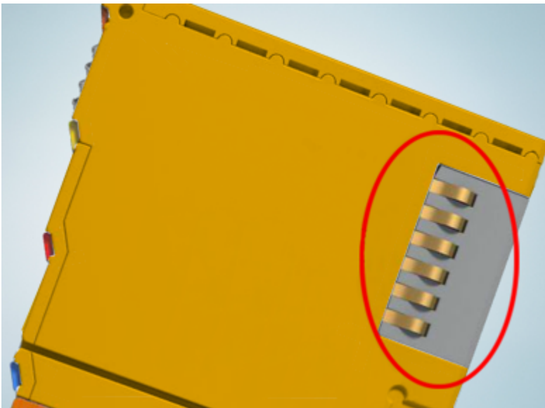
Abb. 7: Federkontakte der Beckhoff I/O-Komponenten
