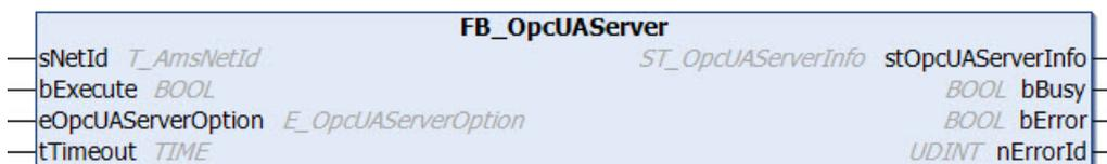
Der Funktionsbaustein ermöglicht das Auslesen von Statusinformationen und Neustarten eines TwinCAT OPC UA Servers.
