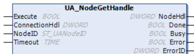
Dieser Funktionsbaustein fragt ein Knotenhandle für ein gegebenes Symbol im UA-Namensraum ab. Das Symbol wird durch ein Verbindungshandle und seine Knoten-ID spezifiziert.
