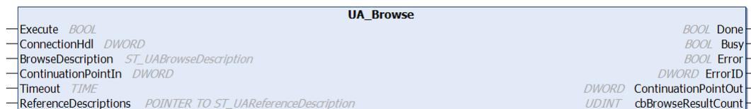
Dieser Funktionsbaustein ermöglicht das Browsen durch den Namensraum eines Servers. Ausgehend von einem Startknoten werden dessen Referenzen ausgelesen und entsprechend zurückgegeben.
