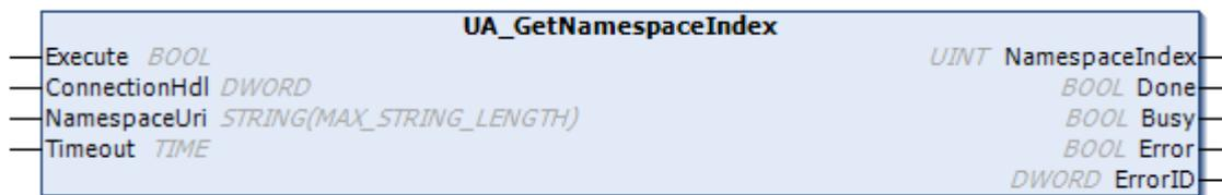
Dieser Funktionsbaustein erfasst den Namespace Index für einen Namespace URI. Der Namespace Index wird für die Identifizierung von Symbolen benötigt, z. B. wenn die Funktionsbausteine [UA\\_Read](#) [[82](#)] oder [UA\\_Write](#) [[85](#)] genutzt werden.
