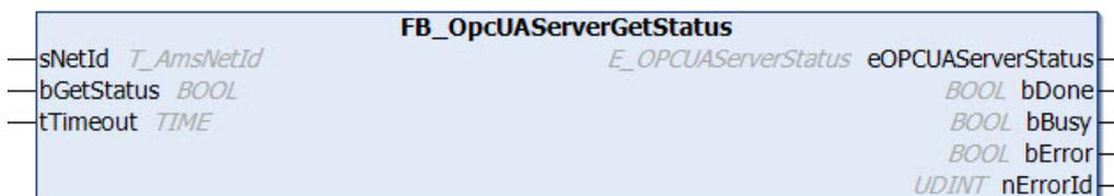
Der Funktionsbaustein ermöglicht das Auslesen des aktuellen Status (Alive, NotResponding) eines TwinCAT OPC UA Servers. An dieser Stelle ist anzumerken, dass sich dieser Funktionsbaustein mit dem ADS-Interface des OPC UA Servers beschäftigt. Wenn der OPC UA-Server neugestartet oder heruntergefahren wird, bleibt das ADS-Interface des Servers erreichbar. Das ADS-Interface lässt sich nur durch Beenden des Server-Prozesses beenden.
