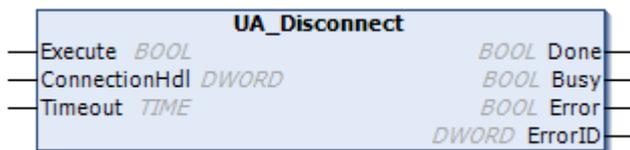
Dieser Funktionsbaustein schließt eine OPC-UA-Remote-Verbindung zu einem anderen OPC UA Server. Die Verbindung wird über ihr Verbindungshandle spezifiziert.
