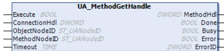
Dieser Funktionsbaustein erfasst ein Handle für eine UA-Methode, das dann für den Aufruf einer Methode über [UA\\_MethodCall](#) [► 74] verwendet werden kann.
