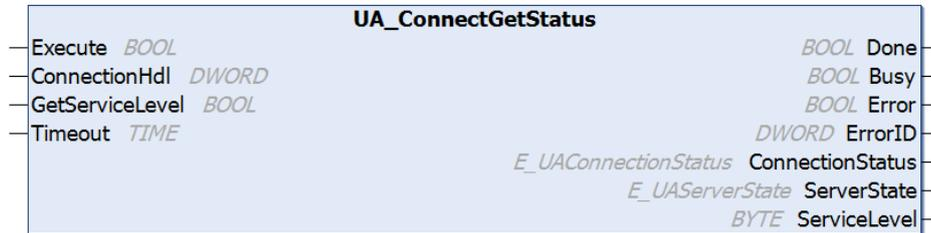
Dieser Funktionsbaustein überprüft den Verbindungsstatus einer existierenden Verbindung zu einem anderen OPC UA Server. Die Verbindung wird hierbei über den jeweiligen Connection Handle referenziert. Der Status wird dann als `E_UAConnectionStatus` [► 53] zurückgegeben. Der Verbindungsstatus wird anhand der internen Session-Info bzw. des OPC UA Heartbeats ermittelt, es wird keine zusätzliche Kommunikation (Read o.ä.) durchgeführt.
