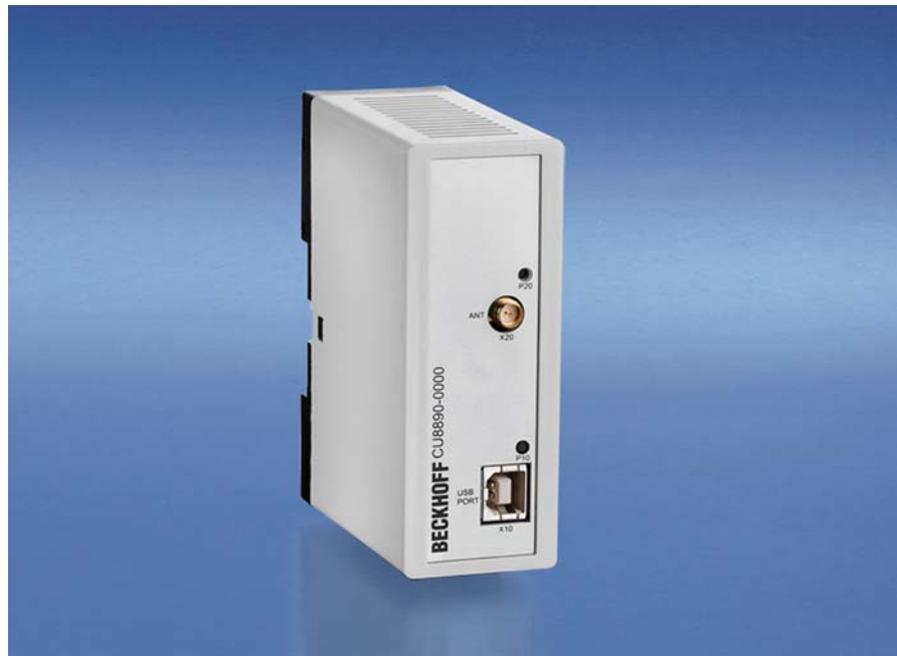
Der industrietaugliche WLAN-Controller CU8890 unterstützt WLAN nach dem Standard IEEE 802.11 b/g und ist für die Schaltschrankmontage vorgesehen. Angeschlossen an einen Beckhoff-IPC kann das Modul sowohl als Access-Point als auch als Client verwendet werden. Client-Treiber stehen für Windows XP, XP Embedded und Windows CE zur Verfügung, somit für jeden Beckhoff IPC sowie die CX-Serie. Diese unterstützen auch den Adhoc-Modus.
