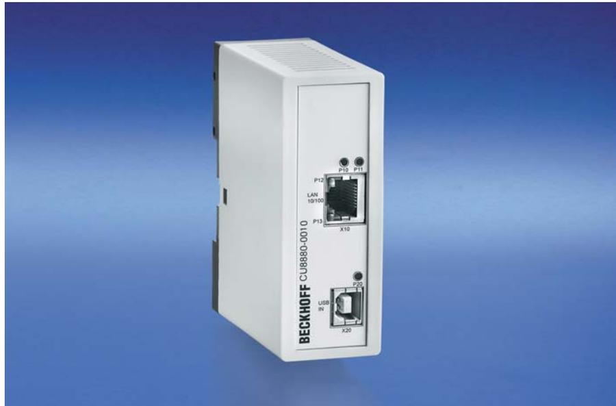
Mit dem USB-zu-LAN-Adapter CU8880-0010 steht dem Anwender eine zusätzliche, industrietaugliche und unabhängige Ethernet-Schnittstelle zur Verfügung. Je nach Systemaufbau können somit vier oder mehr Ethernet-Schnittstellen realisiert werden. Dabei wird der CU8880-0010 für die notwendige IT-Kommunikation verwendet, die jeweiligen On-Board-Ethernet-Schnittstellen stehen für EtherCAT-Kommunikation oder Real-Time-Ethernet-Kommunikation zur Verfügung.
