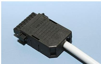
Befestigen Sie das Oberteil des Zugentlastungsgehäuses, in dem Sie es auf das Unterteil aufrasten.
