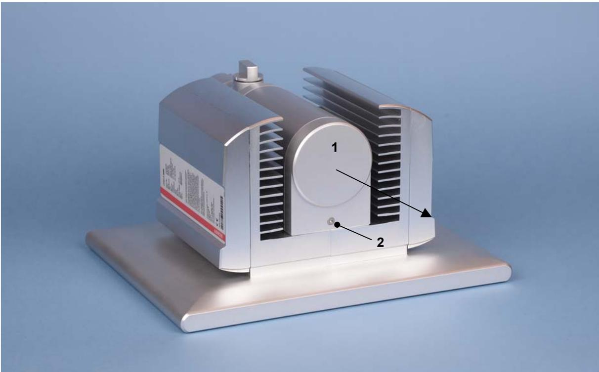
Lösen Sie dazu die Befestigungsschraube (2) mit einem Torx-Schraubendreher T20. Die Abdeckhaube kann jetzt in Pfeilrichtung abgezogen werden (siehe nächste Abbildung).
