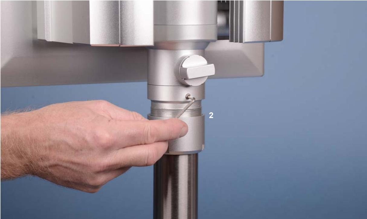
4. Die Überwurfmutter wird nun mit Hilfe des Hakenschlüssels SW 58-62 (3) vorsichtig im Uhrzeigersinn festgezogen.
