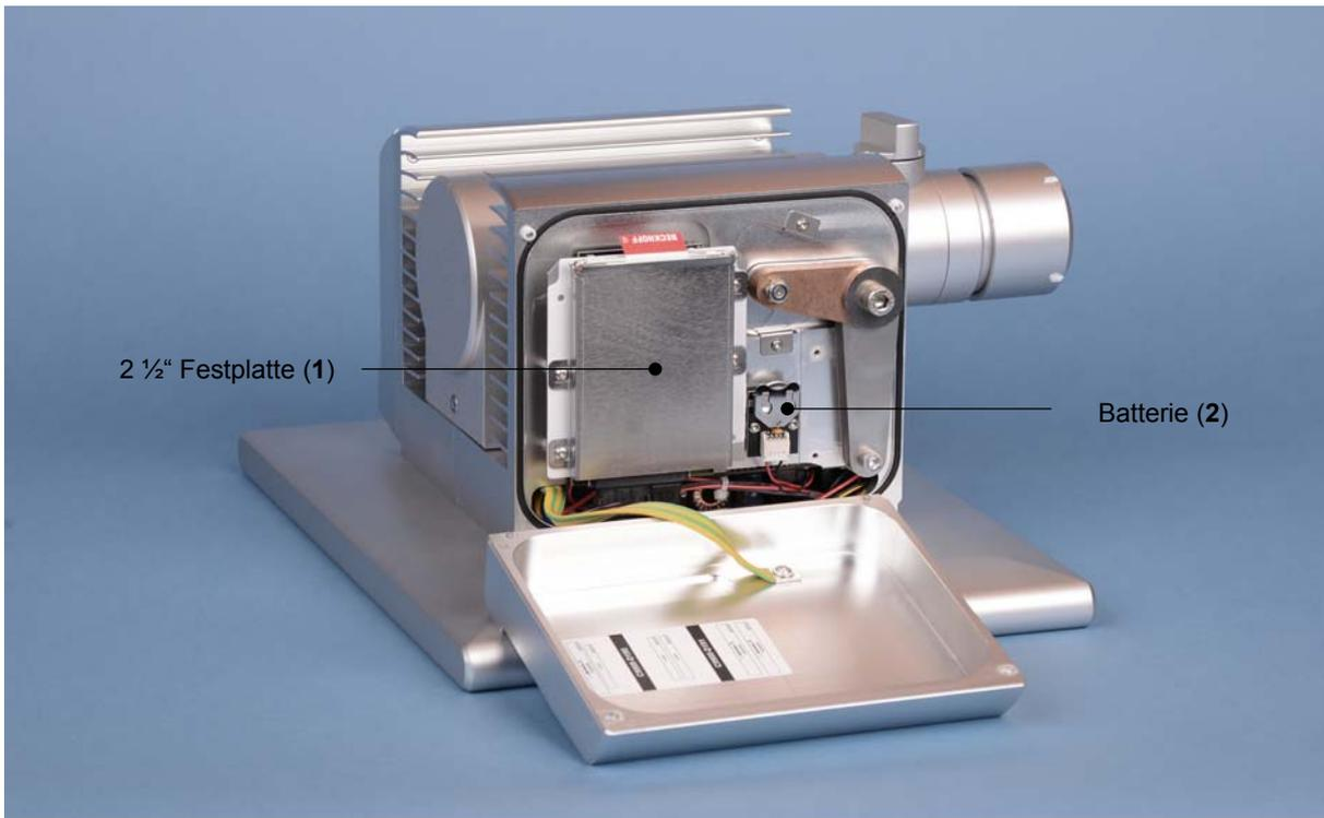
Nach dem Abnehmen der Abdeckhaube erhalten Sie Zugang zur Festplatte (1) sowie der Lithiumbatterie der Systemuhr (2). Das Laufwerk kann nun herausgezogen werden. Der Austausch der Lithiumbatterie ist ebenfalls möglich.
