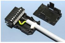
Setzen Sie die Steckerleiste in das Unterteil des Zugentlastungsgehäuses ein. Ziehen Sie den Kabelbinder fest zu und kneifen Sie die Kunststofflasche ab.
