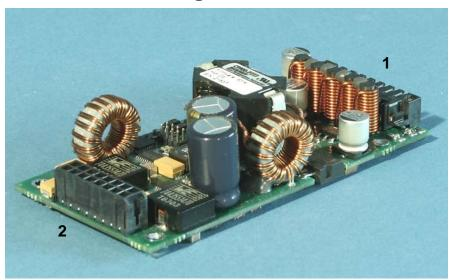
Das Netzteil wird an der dafür vorgesehenen Position im Industrie-PC montiert.
