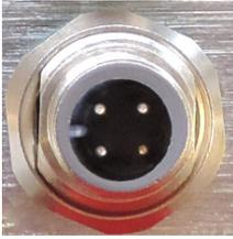
Über die 4polige M12 Buchse, wird die Stromversorgung des Tastermodules hergestellt. Die Schutzart des Rundsteckverbinders entspricht dem IP67-Standard.
