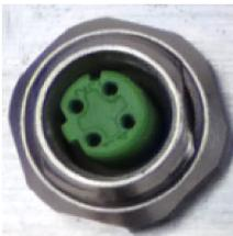
Über die 4 polige M12 Buchse, wird EtherCAT Verbindung hergestellt. Die Schutzart des Rundsteckverbinders entspricht dem IP67-Standard.
