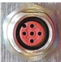
Über den 5poligen Stecker, wird der Not-Halt in der Tastererweiterung verbunden.
