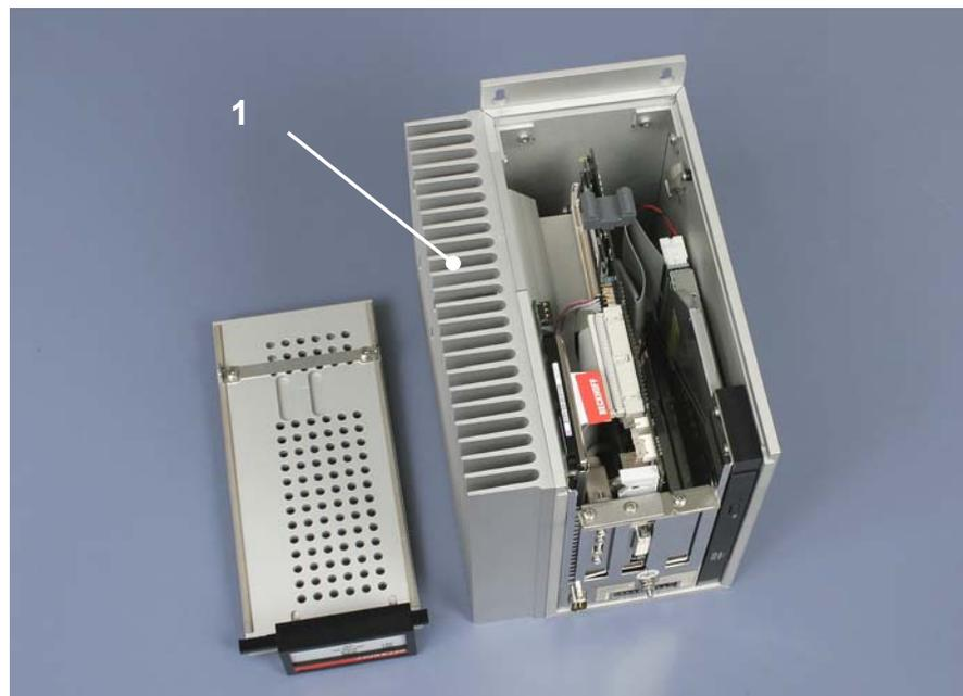
Sie können die Deckelplatte jetzt nach oben abnehmen. Der Kühlkörper (1) ermöglicht den lüfterlosen Betrieb bis zu einer Umgebungstemperatur von 45 °C.
