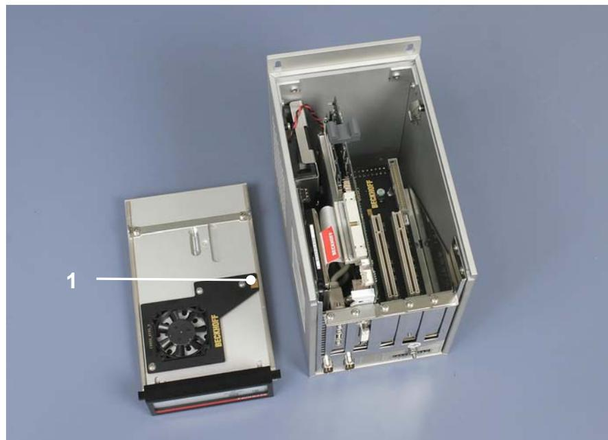
Sie können die Deckelplatte jetzt nach oben abnehmen. Achten Sie darauf, dass die elektrischen Kontakte für die Stromversorgung des Lüfters (1) nicht beschädigt werden!
