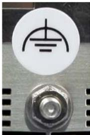
Erdungsverbindungen leiten Störungen ab, die über externe Stromversorgungskabel, Signalkabel oder Kabel zu Peripheriegeräten übertragen werden.
