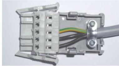
5. Befestigen Sie das Oberteil (Teil **B**) des Zugentlastungsgehäuses, in dem Sie es auf das Unterteil aufrasten.
