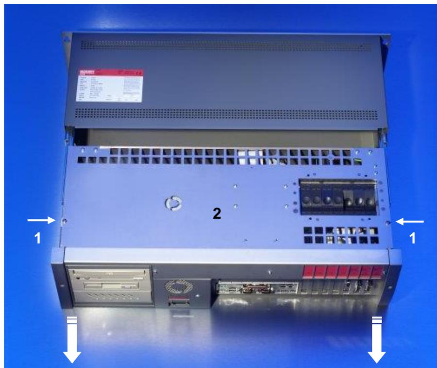
Lösen Sie die beiden Schrauben (1) der oberen Gehäuseabdeckung (2). Danach lässt sich die obere Gehäuseabdeckung einfach nach oben klappen (siehe Foto unten) und ermöglicht so den Zugang zu Diskettenlaufwerk, 3½ Zoll Festplatte, Prozessor, Speicher und Steckkarten.
