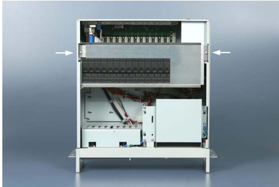
Entfernen Sie die 2 Befestigungsschrauben des Kartenniederhalters (siehe Pfeile) mit einem Kreuzschlitz-Schraubendreher. Der Niederhalter lässt sich dann nach oben abheben.
