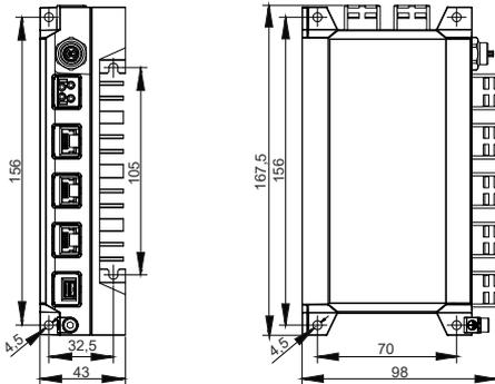
Abb. 12: C7015\_Abmessungen
