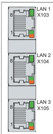
Abb. 5: C7015\_Ethernet-Schnittstellen Pin-Nummerierung
