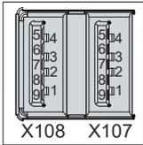
Abb. 8: C7015\_USB-Schnittstellen Pin-Nummerierung
