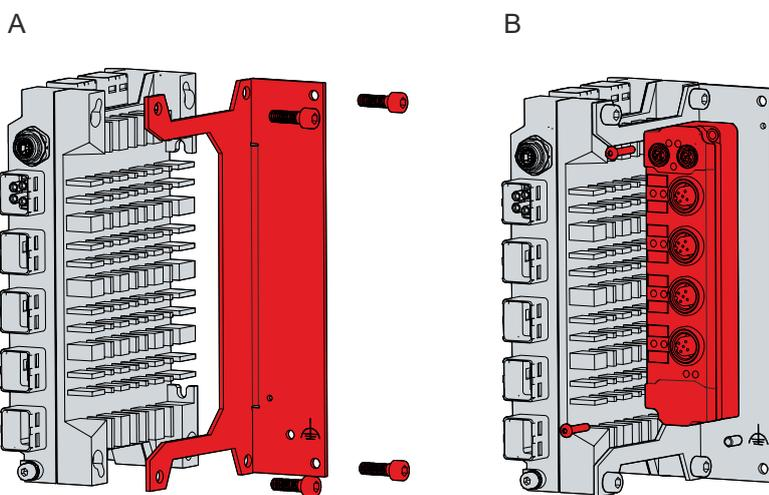
Abb. 16: C7015\_Montage EtherCAT-P-Box-Modul
