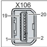
Abb. 7: C7015\_Mini-DisplayPort Pin-Nummerierung
