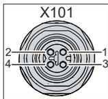
Abb. 2: C7015\_EtherCAT-P-Schnittstelle Pin-Nummerierung
