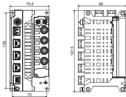
Abb. 13: C7015\_Abmessungen mit ECP-Box-Modul
