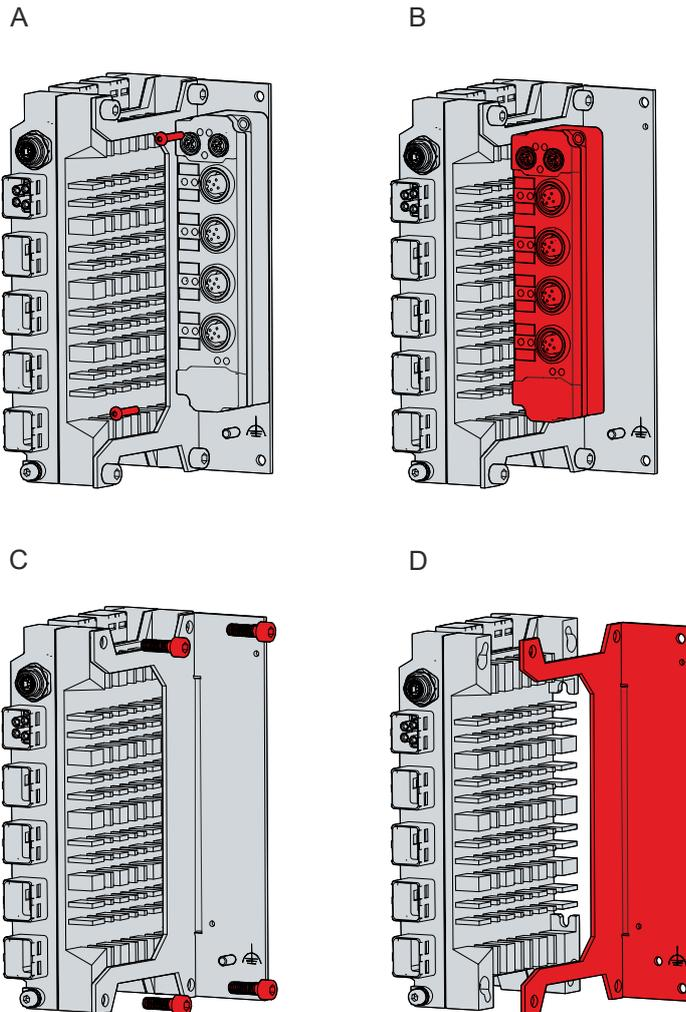
Abb. 24: C7015\_Demontage EtherCAT-P-Box-Modul
