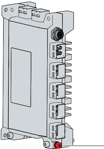
Abb. 19: C7015\_Erdungsbolzen Funktionserdung
