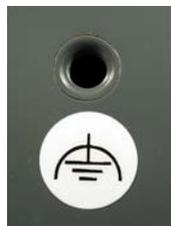
Verbinden Sie daher den Erdungspunkt am PC-Gehäuse niederohmig mit dem zentralen Erdungspunkt der Schaltschrankwand, in die der Rechner eingebaut wird. Der Erdungsanschluss befindet sich auf der Gehäuseunterseite (siehe Foto links).
